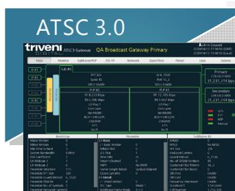
**DESTAQUE:** O Broadcast Gateway da Triveni Digital é uma solução avançada que permite a ingestão de fluxos IP e a transmissão de sinais para excitadores ATSC 3.0. Ele é capaz de receber vários fluxos IP de codificadores e gerar sinais L1 e L2 necessários para transmissão. Além disso, é baseado em software e virtualização, o que garante uma integração eficiente com o codificador de transporte GuideBuilder XM ATSC 3.0, facilitando a transição para a TV 3.0.
